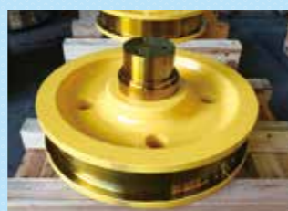
車輪+軸 組立塗装
